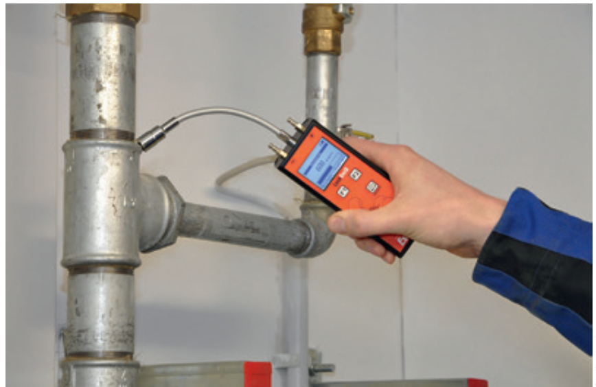
Abb. 3: Die TRGI 2018 sieht vor, dass bei Arbeiten mit geringem Umfang die Dichtheit der Verbindungsstellen z. B. mit einem Gas-Spürgerät nachgewiesen werden kann.
